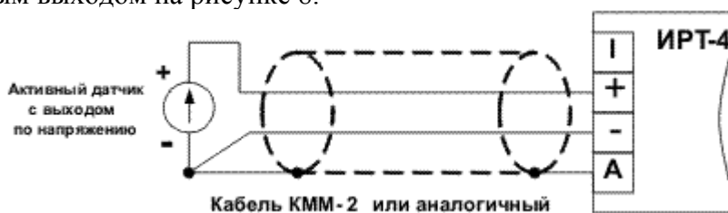
Рисунок 7 Подключение активного датчика с выходом по напряжению
