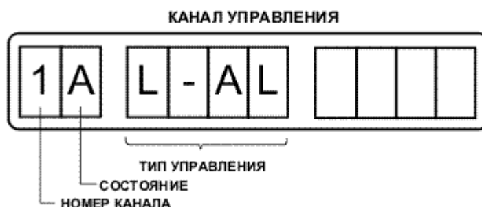
Рисунок 27 Канал управления при контроле состояния объекта
