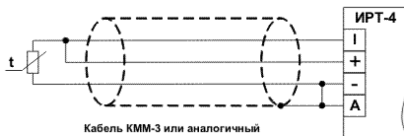
Рисунок 3 Трехпроводная схема подключения ТС
